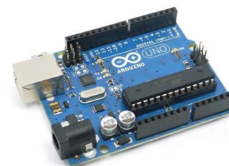
Fig. 2. Arduino Uno R3
